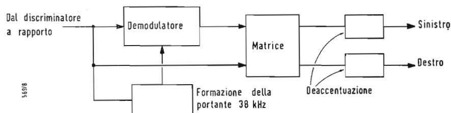
Fig. 1 - Schema a blocchi del circuito senza filtri.
