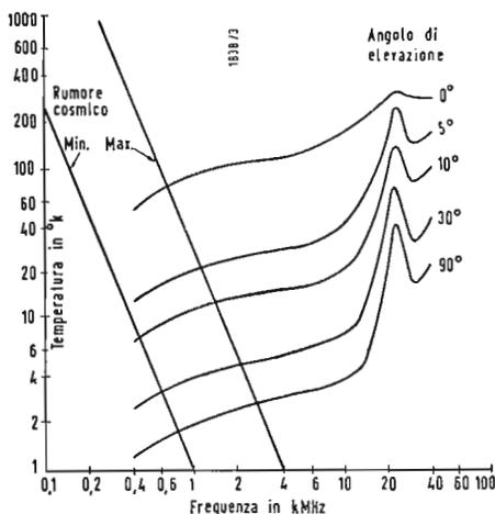
Fig. 2 - Temperatura equivalente d'antenna dovuta a sorgenti cosmiche e all'atmosfera.
