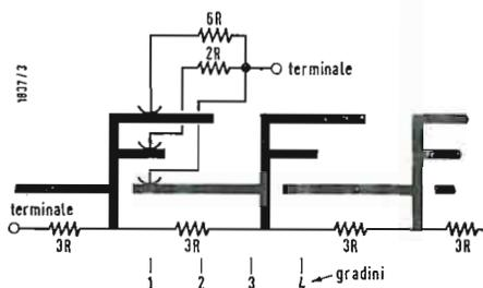
Fig. 3. - Rappresentazione funzionale della sequenza di commutazione.
