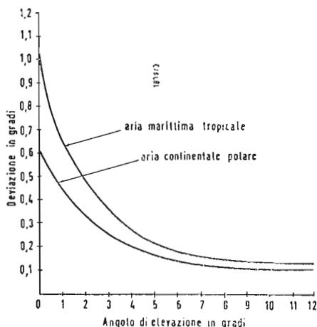
Fig. 3 - Deviazione della direzione di arrivo delle microonde, per effetto della rifrazione atmosferica.
