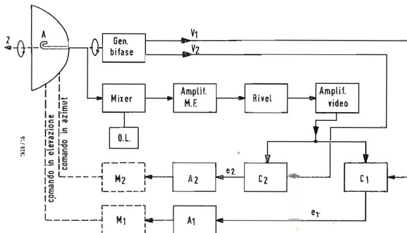
Fig. 6 - Le linee tratteggiate indicano elementi meccanici
