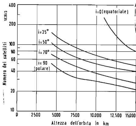
Fig. 1 - Numero dei satelliti necessari per assicurare le comunicazioni per il 99,9% del tempo fra Europa e Stati Uniti.
