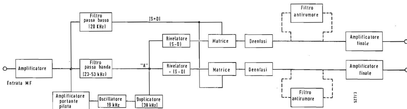
Fig. 2 - Diagramma a blocchi del modello MX-101.
