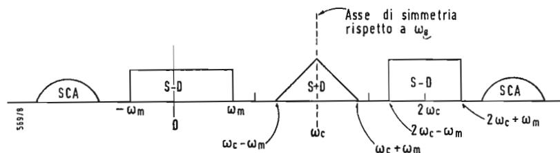
Fig. 5 - Spettro spostato della quantità  $\omega_c$ .
